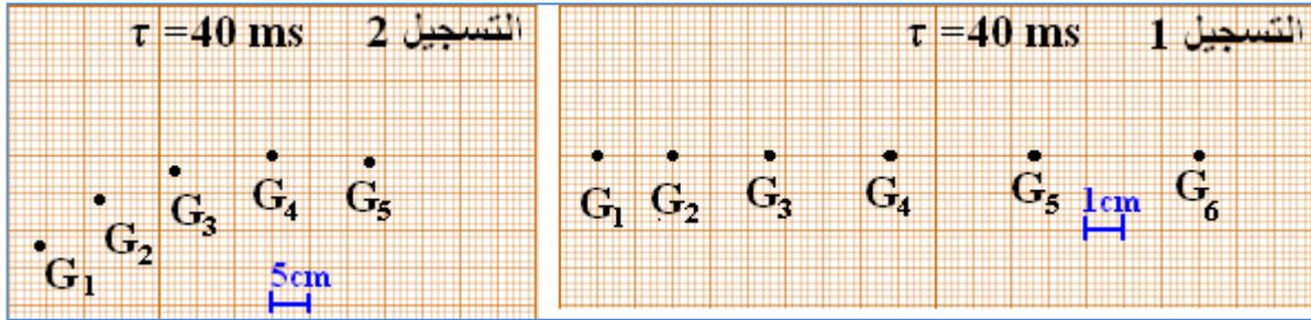
أ- احسب بالنسبة لكل تسجيل  $V_2$  و  $V_4$  سرعة  $G$  مركز قصور الحامل الذاتي في الموضعين  $G_2$  و  $G_4$ .
